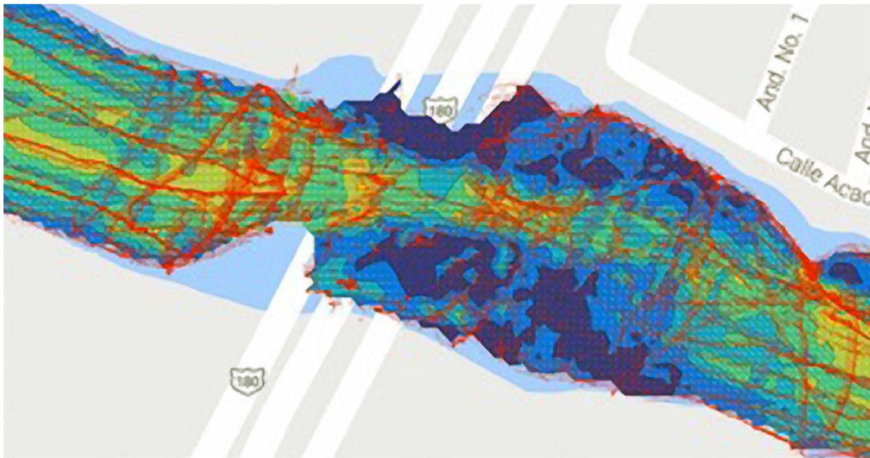
Medición del campo de velocidades en la zona de los puentes.
