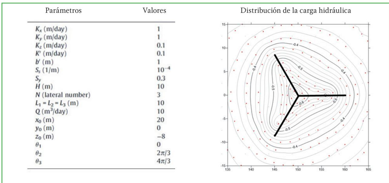
la finalidad de investigar la interacción entre los pozos radiales y un sistema acuífero-río, utilizando modelos analíticos y numéricos del flujo del agua subterránea.
