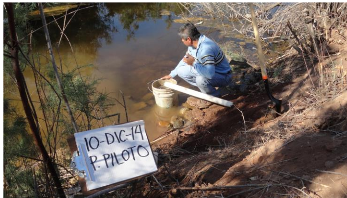
Aforo en desagüe del molino de viento.
