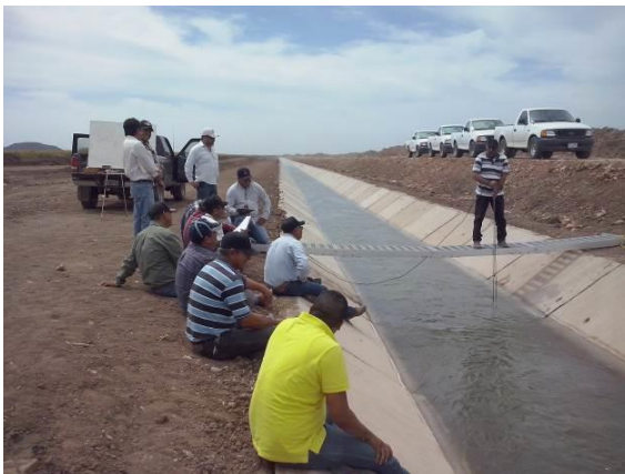
Aforo en punto de control y seguimiento de riego en módulo II-2 Tetameche.
