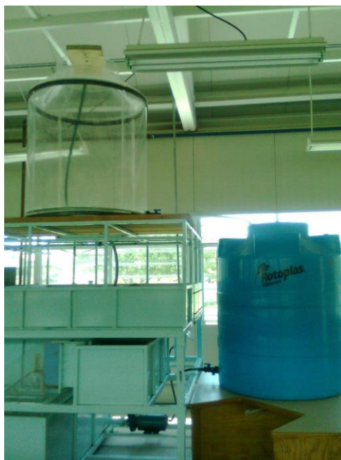
Modelo físico de tinaco en acrílico.
