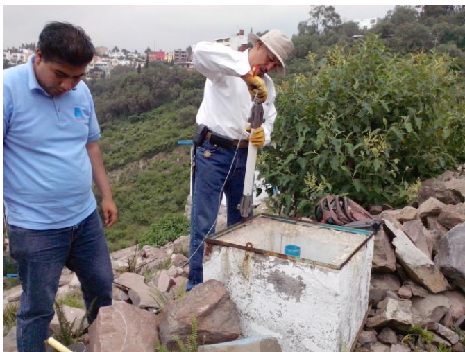
Empleo del prototipo del Inclínómetro desarrollado en el IMTA, en la Presa Madín, Estado de México, para evaluar el desempeño del instrumento y sus posibles modificaciones.
