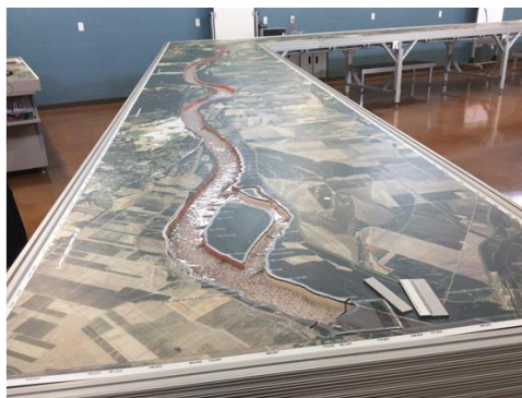
Micromodelo del río Mississipi, donde se observa una gran isla y las obras de protección.
