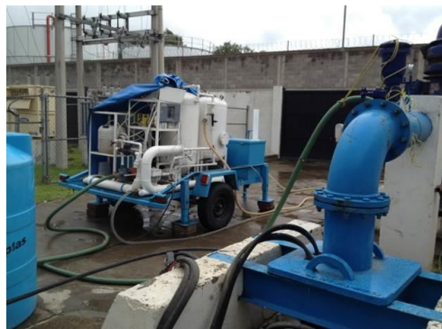
Planta piloto (filtración directa).
