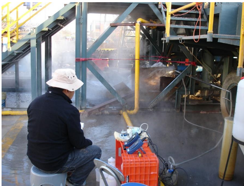
Toma de muestras de agua y medición de parámetros de campo en el pozo exploratorio San Lorenzo Tezonco.
