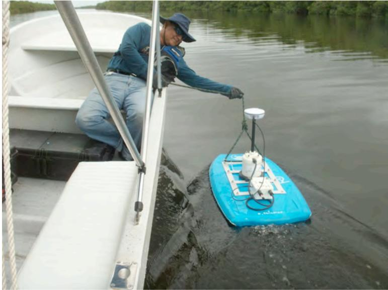
**Medición de aforo en el río Hondo en la estación Subteniente López, con equipo de perfilación acústica multifrecuencia.**
