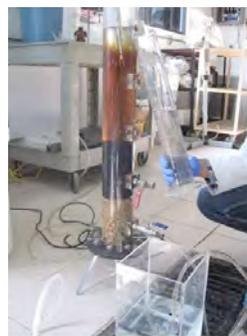
Pruebas de regeneración del adsorbente.
