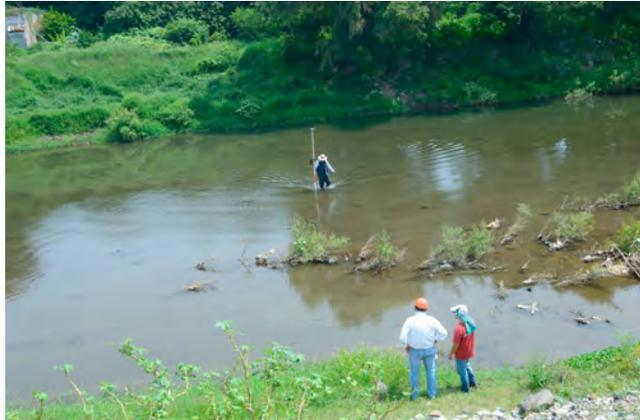
Levantamiento del perfil del río con GPS de alta precisión, en una sección del río Yautepec.
