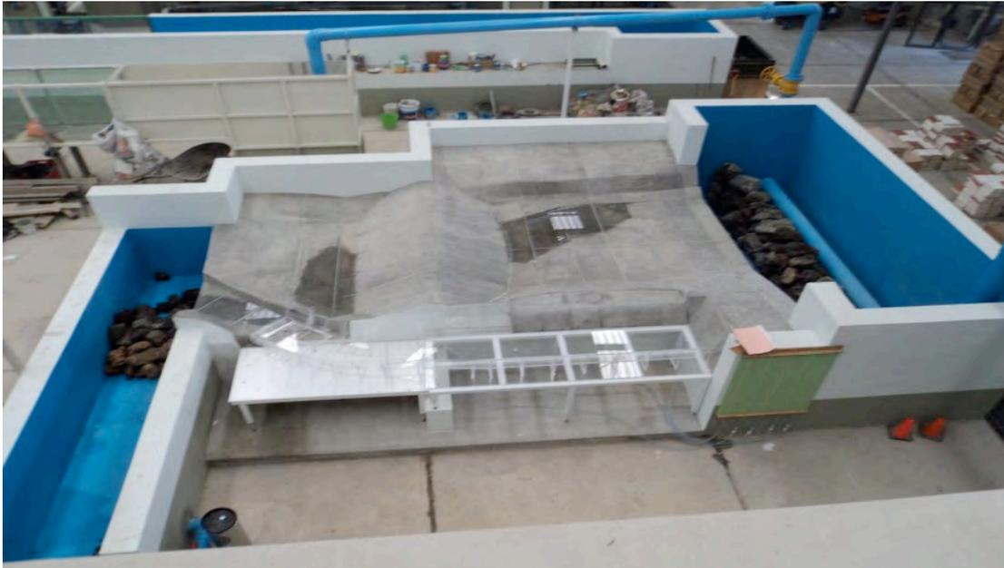
**Modelación física del vertedor de la presa El Túnel, Morelos.**
