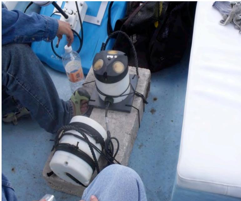
**Equipo de perfilación acústica de fondo para medir nivel, gasto y volumen totalizado, instalado en la estación de aforo Juan Sarabia.**
