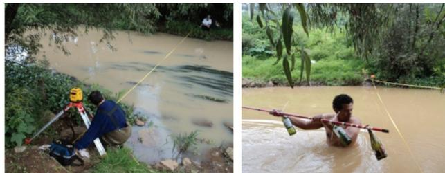
Medición de caudal y muestreo de sedimentos en el dren Tzurumútaró (cauce perenne).
