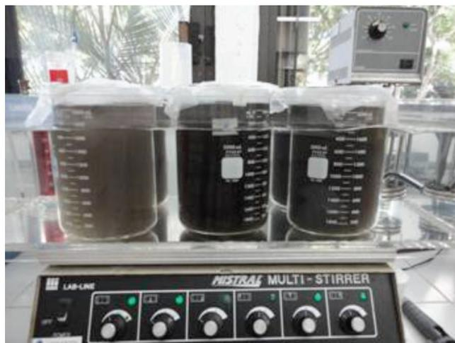
Pruebas de adsorción de fluoruros con carbón de hueso a temperatura constante.
