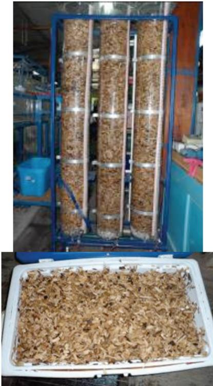
Prototipo experimental y materiales de empaque del biofiltro.
