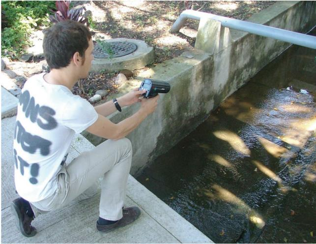
Realización de pruebas con el radar portátil de efecto Doppler.
