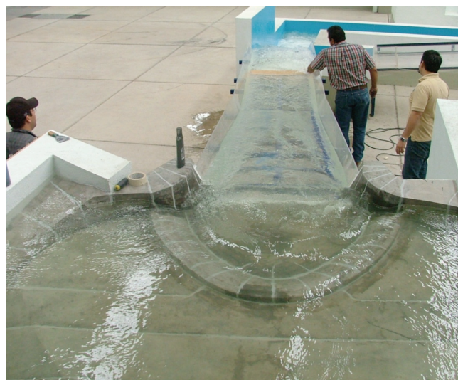
Modelación física del vertedor de la presa Los Naranjos, Sinaloa.
