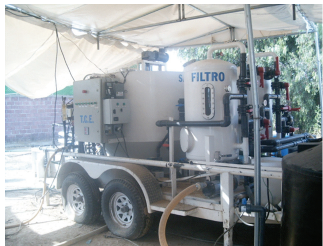
Planta piloto para realizar el tratamiento coagulación asistida por redox.
