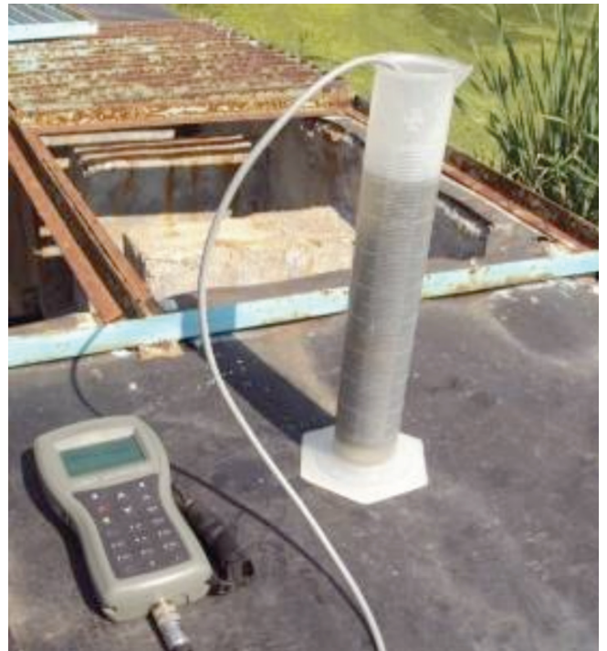
Medición de tiempos de residencia hidráulica.
