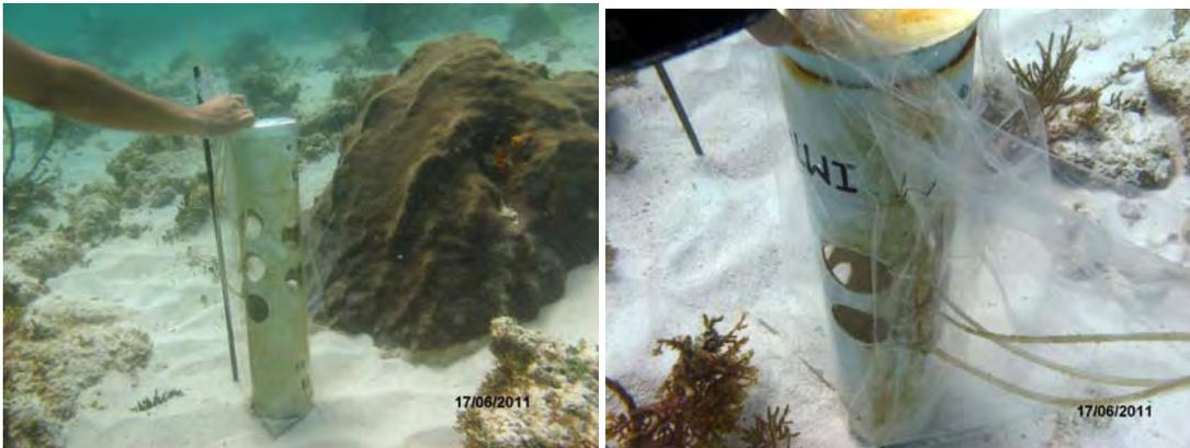
**Técnica de recolección de la muestra de sedimentos para la obtención de tasa de sedimentación en la zona de arrecifes.**
