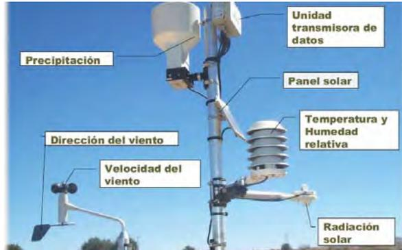
**Tipo de sensores calibrados.**
