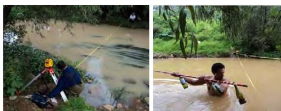
**Medición de caudal y muestreo de sedimentos en el dren Tzurumútaru (cauce perenne).**
