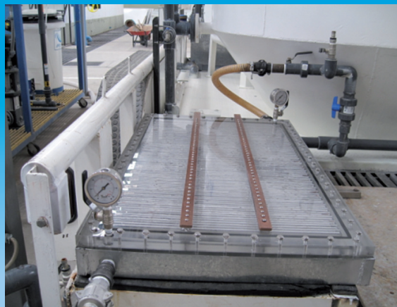
Prototipo de reactor electroquímico para electrocoagulación.
