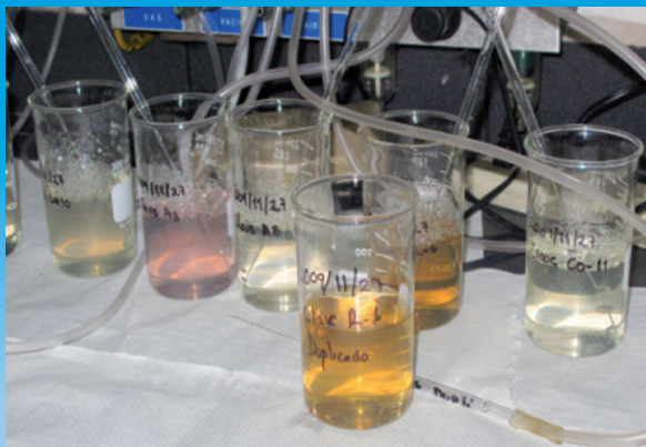
Tratamiento de aireación para el análisis de reducción de toxicidad con Vibrio fischeri .
