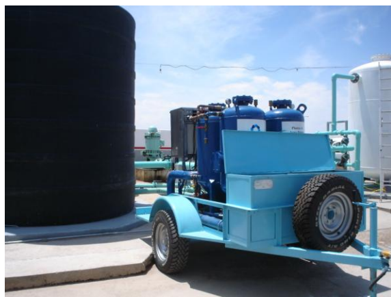
Planta piloto para realizar pruebas in situ de remoción de arsénico.
