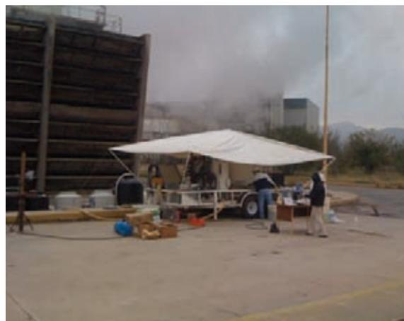
Planta piloto acoplada a la torre de enfriamiento de la central termoeléctrica Guadalupe Victoria, Comisión Federal de Electricidad en Lerdo, Durango.
