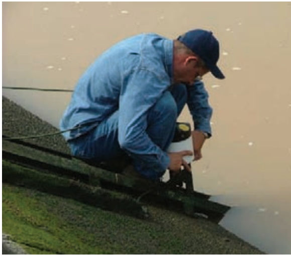
Limpieza de un medidor acústico de efecto Doppler lateral fijo.
