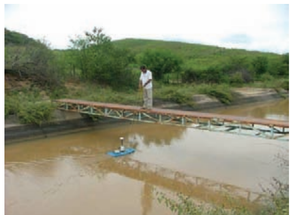
Estación de medición con un aforador de garganta larga (izquierda). Determinación del caudal con un equipo de perfilación acústica Doppler portátil (derecha).
