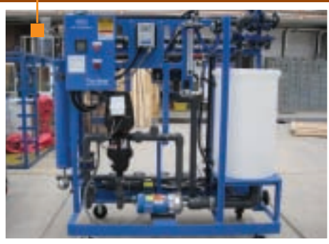
Equipo piloto móvil de microfiltración y ultrafiltración.
