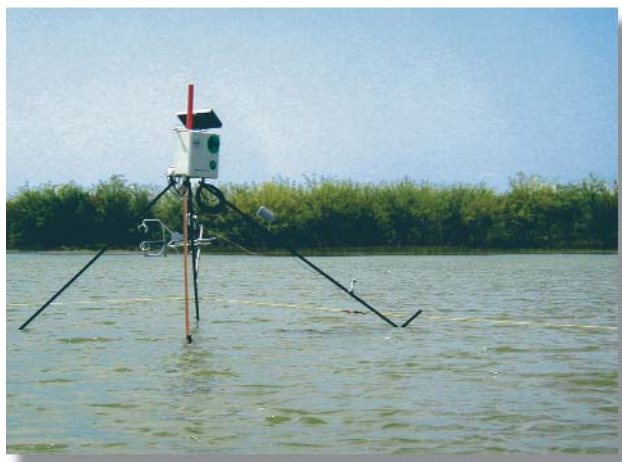
EQUIPO DE MEDICIÓN DE EVAPORACIÓN POR CORRELACIÓN TURBULENTA
