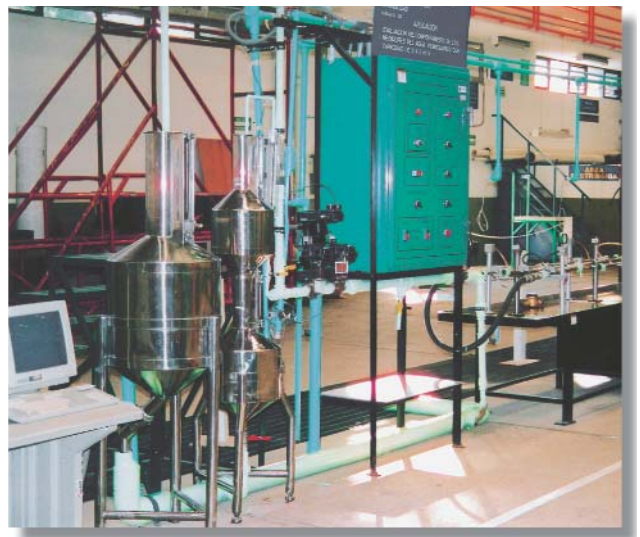
BANCO DE PRUEBAS DE MEDIDORES DOMICILIARIOS
