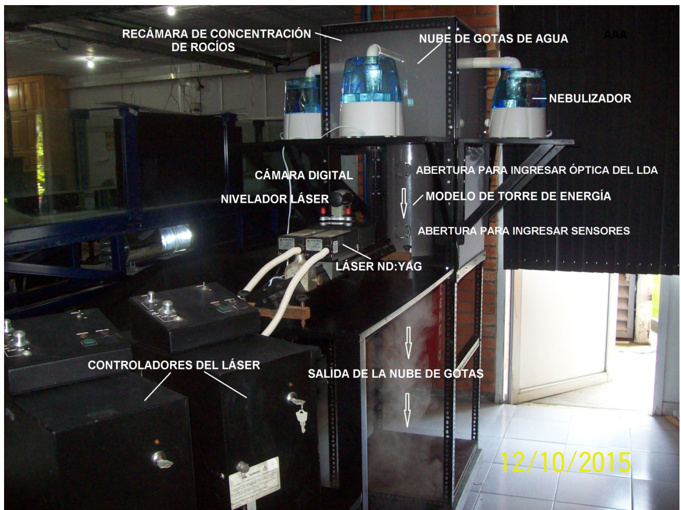
Foto 1. Dispositivo experimental construido en el Laboratorio de Transferencia de Energía y Masa, y algunos instrumentos. Los nebulizadores o generadores de rocío se encuentran en operación.
