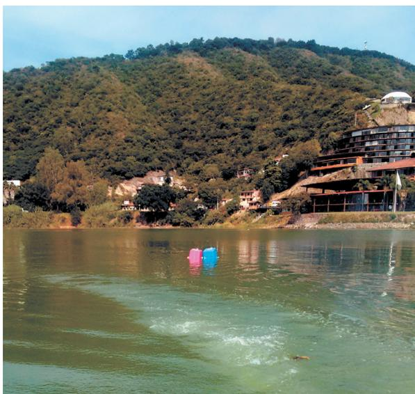
Cámaras flotantes para la medición de GEI en el embalse Valle de Bravo.
