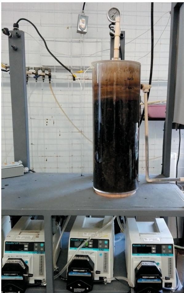
Reactor con biomasa inmovilizada y membrana sumergida.
