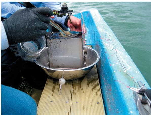
Obtención de muestra de sedimento en la presa Valle de Bravo, mediante draga Ekman.
