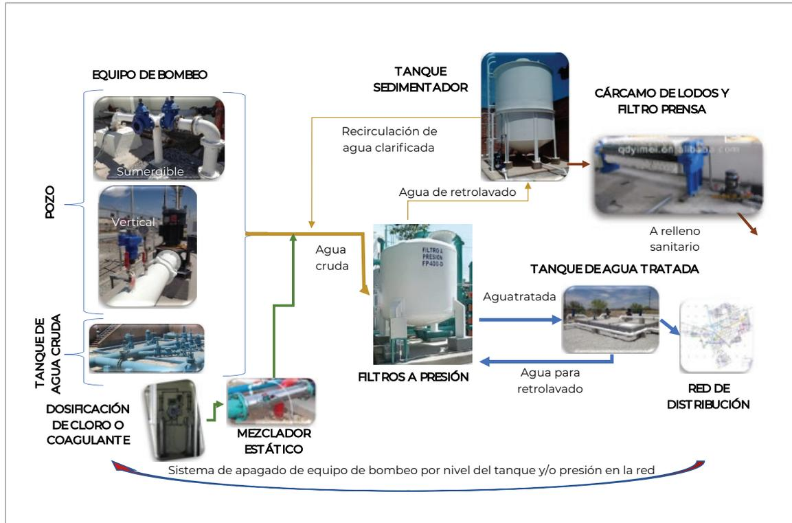
**Figura Introducción 3.** Esquema general de proceso de una planta potabilizadora de filtración directa con filtros a presión
