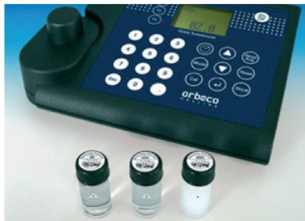
**Figura 5.** Colorímetro, instrumento para hacer mediciones de calidad de agua
