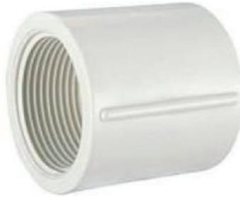
Adaptador PVC: un extremo con rosca interior y otro liso para cementar
