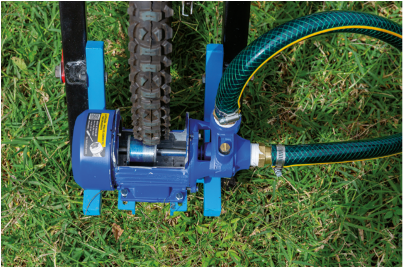
Figura 31. Esquema del armado final de la bicibomba – paso 3.
