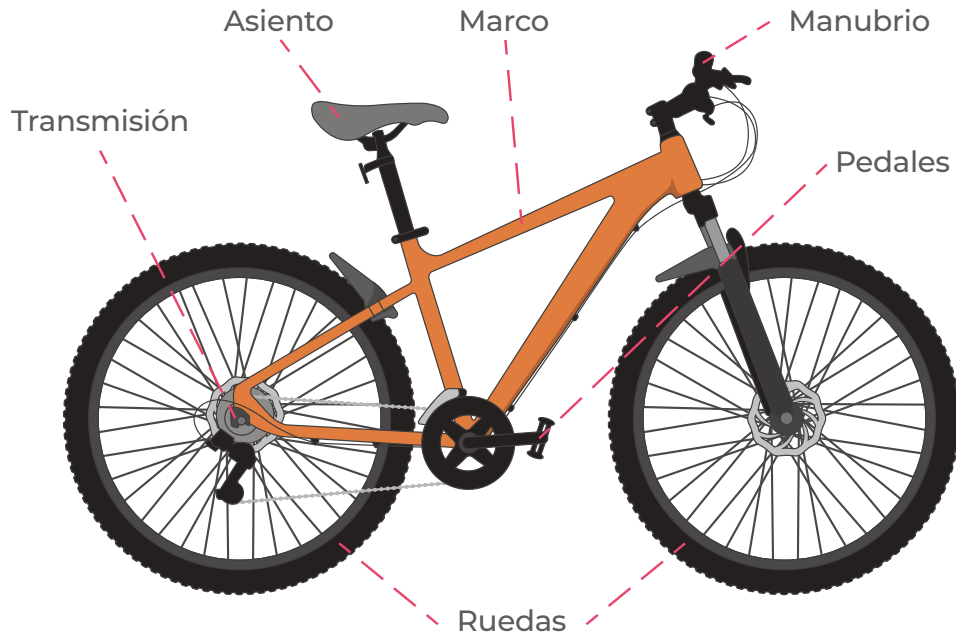
Figura 2. Partes de una bicicleta.
