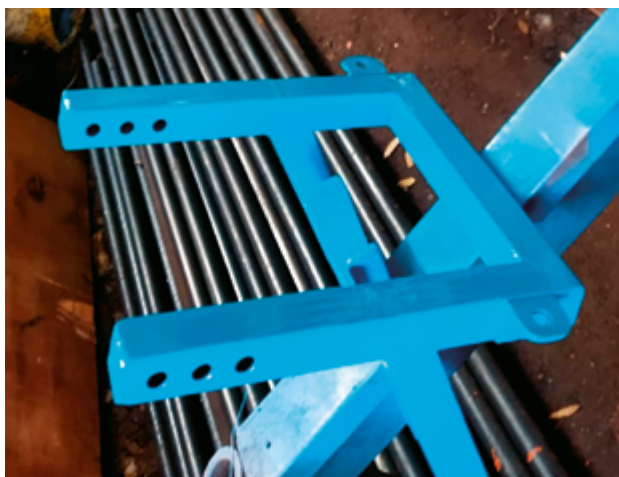
Figura 23. Pintura de los elementos de manera individual.
