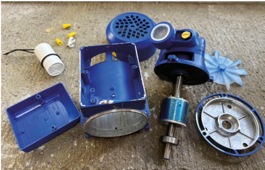
Figura 11. Bomba centrífuga desarmada.
