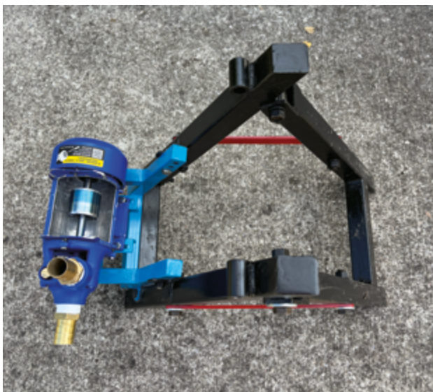
Figura 27. Vista de la estructura de soporte finalizada, con la bomba acoplada.
