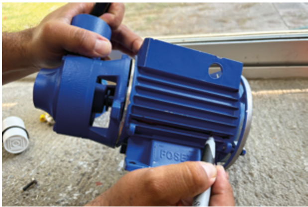
Figura 12. Marcación del corte a realizar en la carcasa de la bomba.
