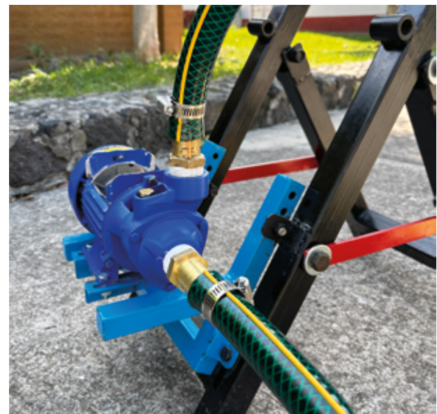
Figura 28. Esquema del armado final de la bicibomba – paso 1
