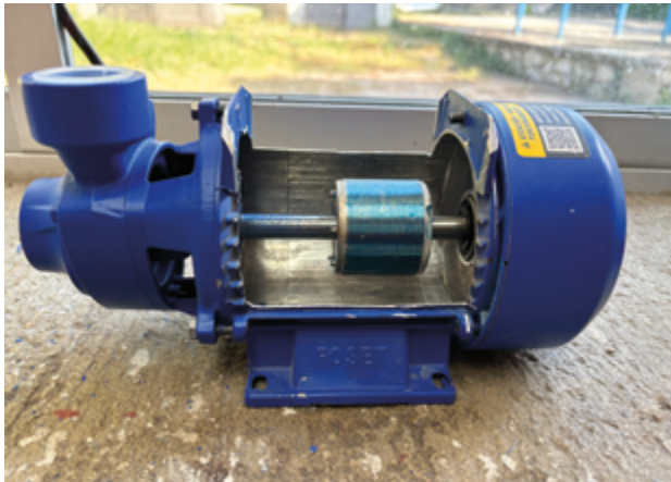
Figura 14. Ejemplo del corte de la carcasa.
