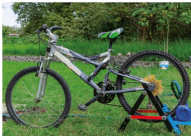
Figura 4. Bicibomba implementada por el IMTA.
