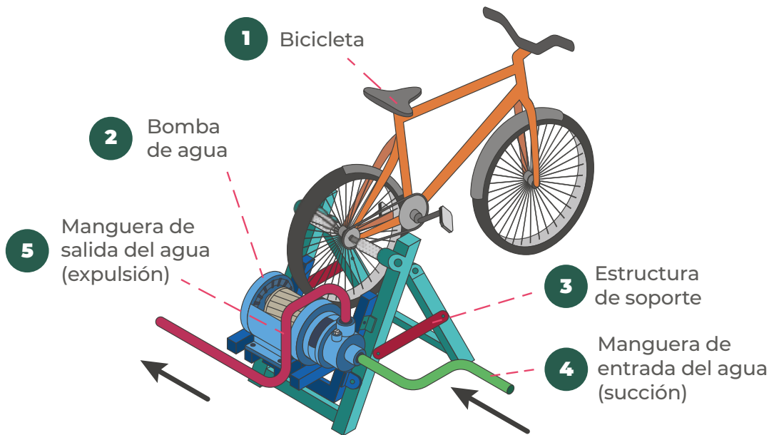
Figura 3. Componentes de la bicibomba.
