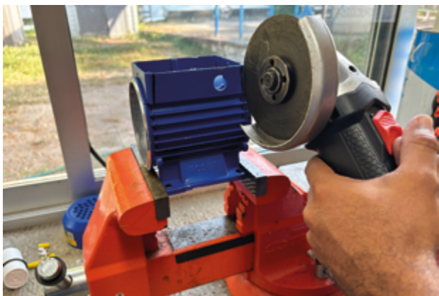
Figura 12. Marcación del corte a realizar en la carcasa de la bomba.
