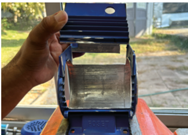
Figura 13. Proceso del corte de la carcasa.
