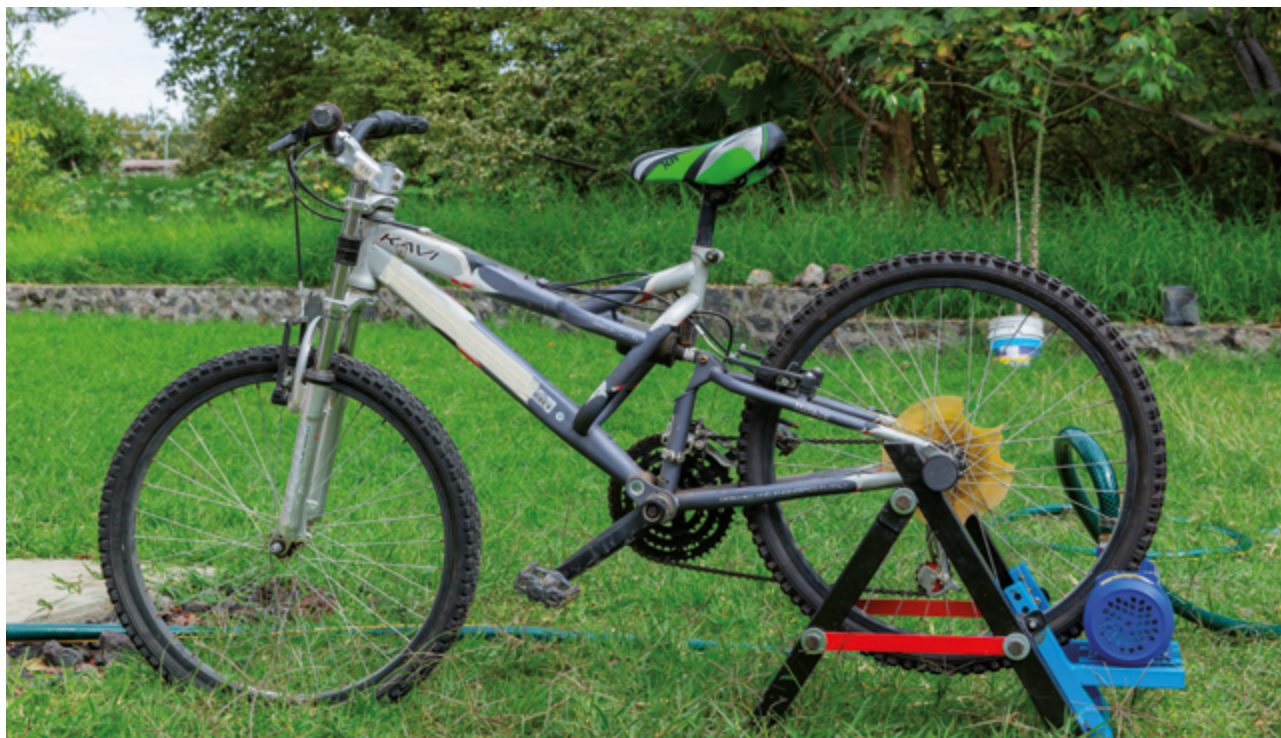
Figura 30. Esquema del armado final de la bicibomba – paso 2
