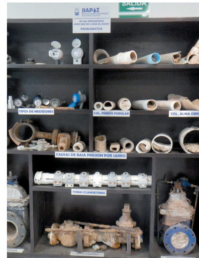
Problema de incrustación y clandestinaje en la red de distribución de la JIAPAZ, que ocasionan una operación deficiente y servicio tandeado.
