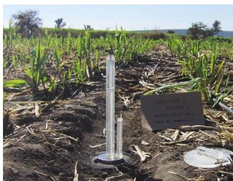
**Figura 6.4** Prueba de infiltración de suelos
