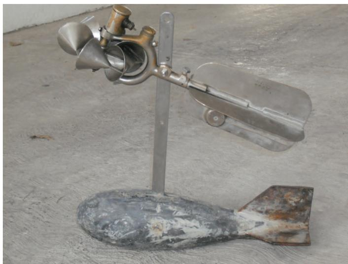
**Figura 40. Molinete, timón y escandallo (torpedo) de 5 kg de lastre.**
