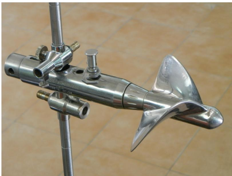
Figura 26. Molinete de hélice marca *Hydrological Services*.
