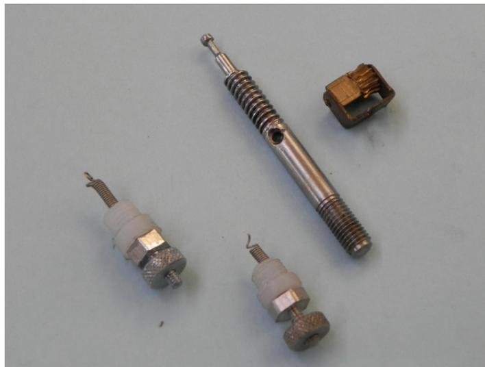
**Figura 29. Componentes básicos de la cámara de contactos.**
