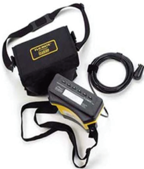
Figura 3 (a) Flujómetro Flowmate 2000 con el cual se tomaron las velocidades del caudal, (b) toma de velocidades en el Dren Tzurumútaro.
