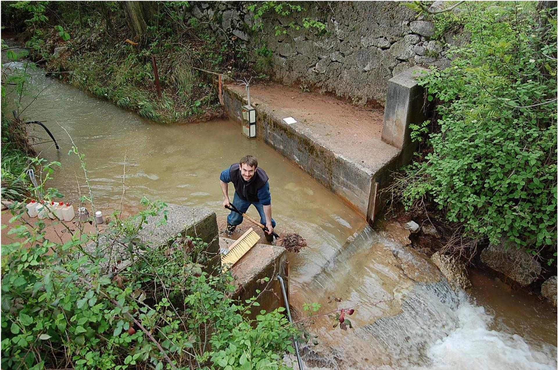
**Aforador** en cabecera del río Llobregat; sección compuesta y compleja; es necesaria una gran precisión.
