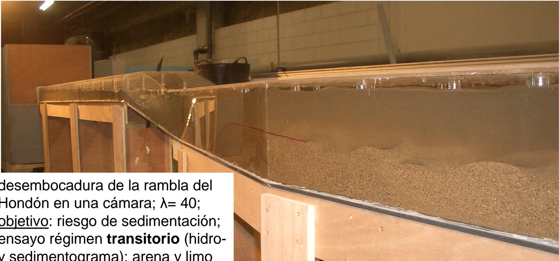
desembocadura de la rambla del Hondón en una cámara;  $\lambda = 40$ ; objetivo: riesgo de sedimentación; ensayo régimen **transitorio** (hidro y sedimentograma); arena y limo en el modelo a escala del prototipo
