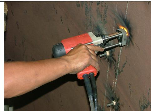
Procesos de fijación mediante soldadura de arco convencional, y pernos autosoldables.
