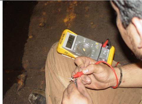
Excitación de la cara del sensor y verificación del pico de voltaje generado al otro extremo de la línea de transmisión de señal.
