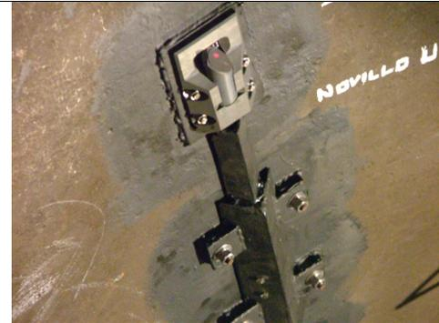
Una vez que los sensores han sido colocados, conectados y alineados se verifica la posición geométrica de cada uno de ellos determinada con anterioridad.
