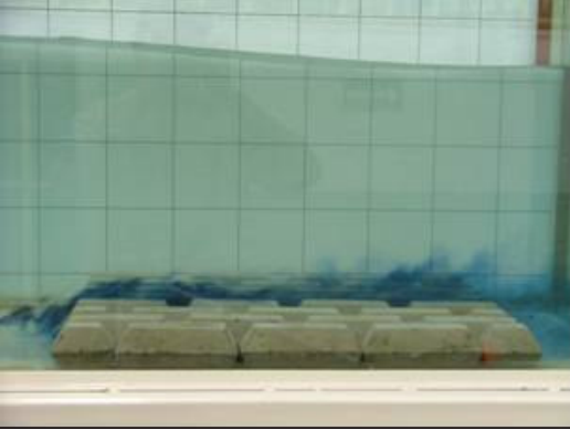
Fotografía 1. Vista del flujo sobre el tapete 1 mediante un trazador colorante. Se aprecia el efecto del tapete sobre el flujo.
