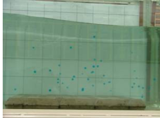
Fotografía 2. Vista del flujo sobre el tapete 1 mediante un trazador partículas sumergidas.
