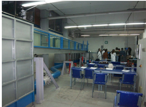
Figura 1. Entrega de canal de pendiente variable y un total de 12 módulos didácticos de hidráulica básica en el laboratorio de la UAEH.
