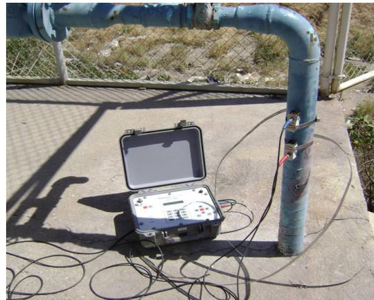
2. Verificación a través de muestreo de las inexactitudes de los medidores instalados en conexiones de servicio.
