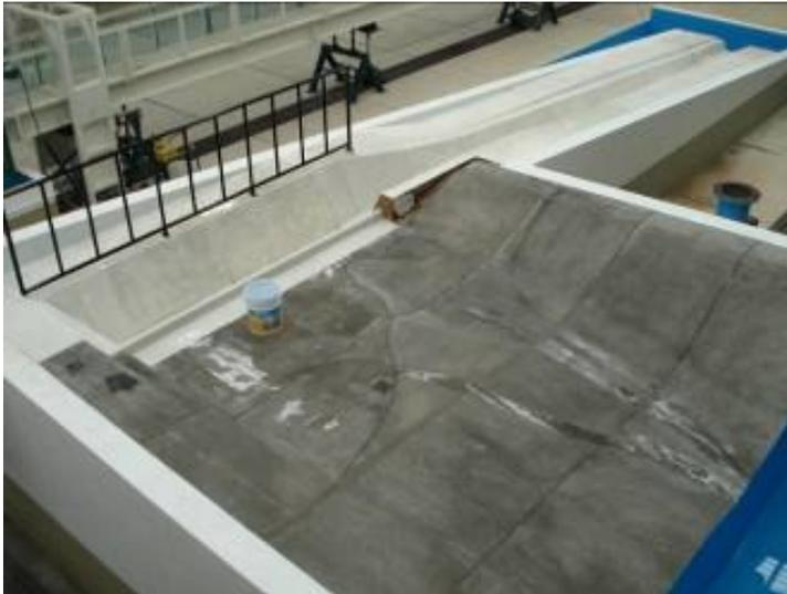
**Configuración del modelo físico del vertedor de la Presa Coyotes**
