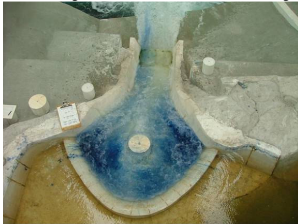
Figura 2. Vertedor de abanico con una pila cilíndrica en la parte central
