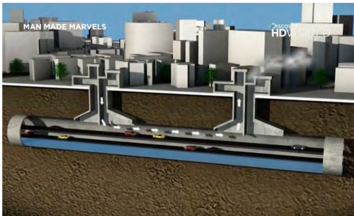
Figura 12.2. Infraestructura multipropósito: túnel SMART.
